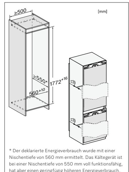
\* Der deklarierte Energieverbrauch wurde mit einer Nischentiefe von 560 mm ermittelt. Das Kältegerät ist bei einer Nischentiefe von 550 mm voll funktionsfähig, hat aber einen geringfügig höheren Energieverbrauch.
